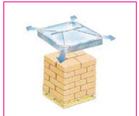
3 ขั้นตอนถ่างมุ้ง (Hood): อัตราการถ่างขึ้นกับมิติของพาเลตและความยืดหยุ่นของฟิล์ม Stretching of the hood; the degree of stretch is defined by the stack dimensions, film elasticity and film gusset dimensions
