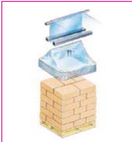
2 ขั้นตอนสร้างมุ้ง (Hood): หลังจากนั้นเครื่องจะซีลฟิล์มเพื่อให้เป็นมุ้ง (Hood) และกำหนดความยาวของฟิล์มตามความสูงของพาเลตที่ต้องการครอบ Uniform crimping of the hood; sealing and lengthening to a particular size which has been determined by previous sensing of the stack height
