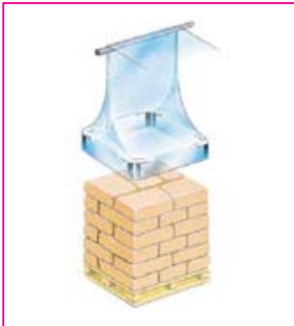
1 ถ่างฟิล์มออกเพื่อส่งต่อไปยังจุดยึดและถ่างฟิล์ม Spreading of the film hood and transfer into crimping and stretching unit
