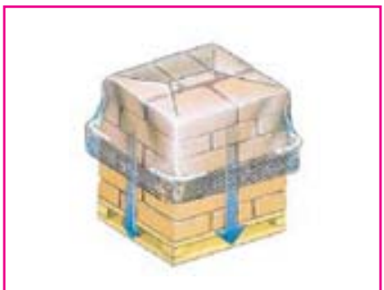
4 ครอบมุ้งลง พร้อมกันนั้นดึงฟิล์มลงตามแนวตั้ง เพื่อให้เกิดการดึงทั้งสองแนว คือแนวตั้งและแนวราบ Lowering of the stretch angles and simultaneous stretching of the film in a vertical direction: "biaxial stretch"
