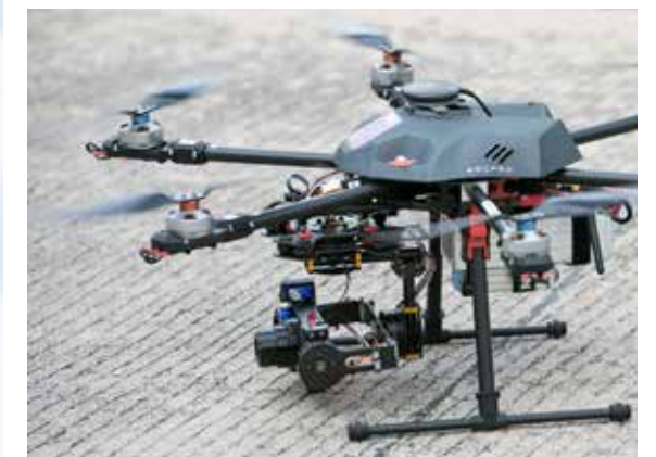
■ หุ่นยนต์บินสำรวจ Aerial Visual Inspection Robot
